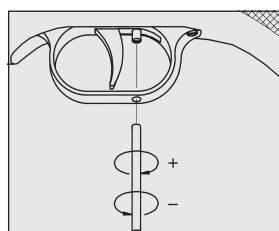
Das Abzugsgewicht kann durch Rechtsdrehung der Schraube („+“) erhöht und durch Linksdrehung („-“) erleichtert werden.
