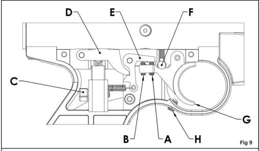
A. FIRST STAGE ADJUSTER B. SECOND STAGE ADJUSTER C. TRIGGER WEIGHT ADJUSTER D. SEAR E. LINK F. SAFETY G. TRIGGER H. TRIGGER OVERTRAVEL SCREW
